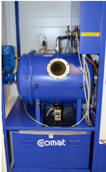
Herzstück: Der Filter enthält die Filterscheiben mit dem angeschwemmten Filterkuchen. (Bilder: TR)
