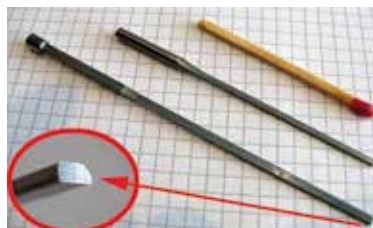
Stanzen für die Rotorbleche von Mikro-Elektromotoren mit hohen Ansprüchen an die Konturgenauigkeit
