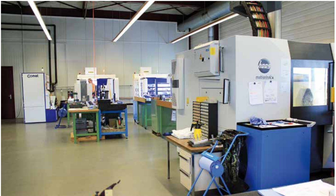
Sauber und aufgeräumt: Eine der Maschinenhallen. Rechts ein 5-Achs-Schleifzentrum von Haas, im Hintergrund zwei Schältschleifsysteme von Rollomatic
