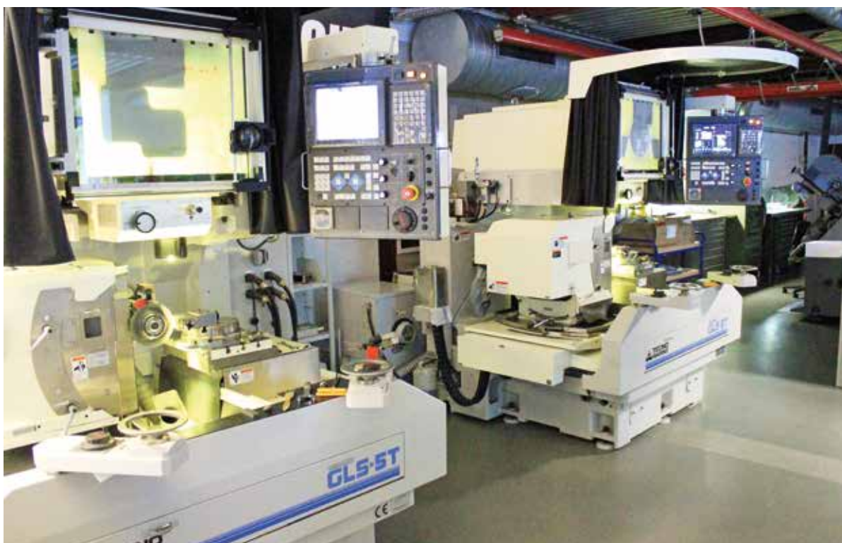
Projektionsoptische Schleifmaschinen von Amada, die kleinste Zustellbewegungen mit einer Schrittweite von lediglich 0,1 \mu\text{m} ausführen können
