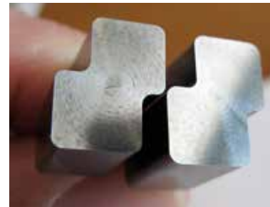
Mithilfe des projektiionsoptischen Schleifens hochgenau bearbeitete kundenspezifische Go/NoGo-Prüflehren
