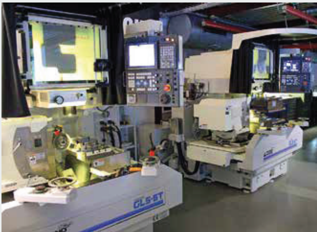
Schleifmaschinen von Amada, die kleinste Zustellbewegungen mit einer Schrittweite von lediglich 0,1 µm ausführen können.
