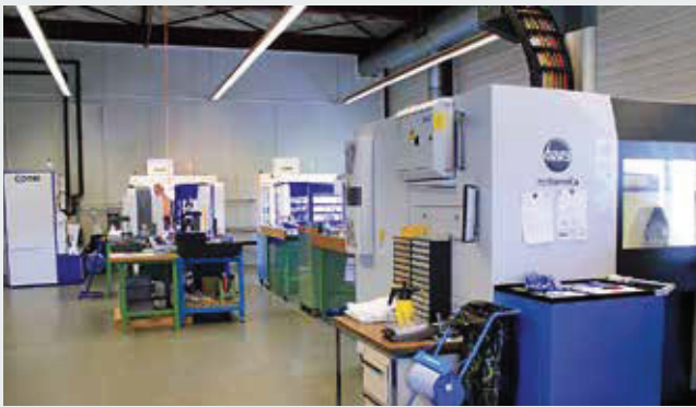
Eine der Maschinenhallen: Rechts ein 5-Achs-Schleifzentrum von Haas, im Hintergrund zwei Schältschleifsysteme von Rollomatic.
