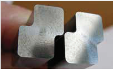
Mithilfe des projektionsoptischen Schleifens hochgenau bearbeitete kundenspezifische Go/No-Go-Prüflehren.
