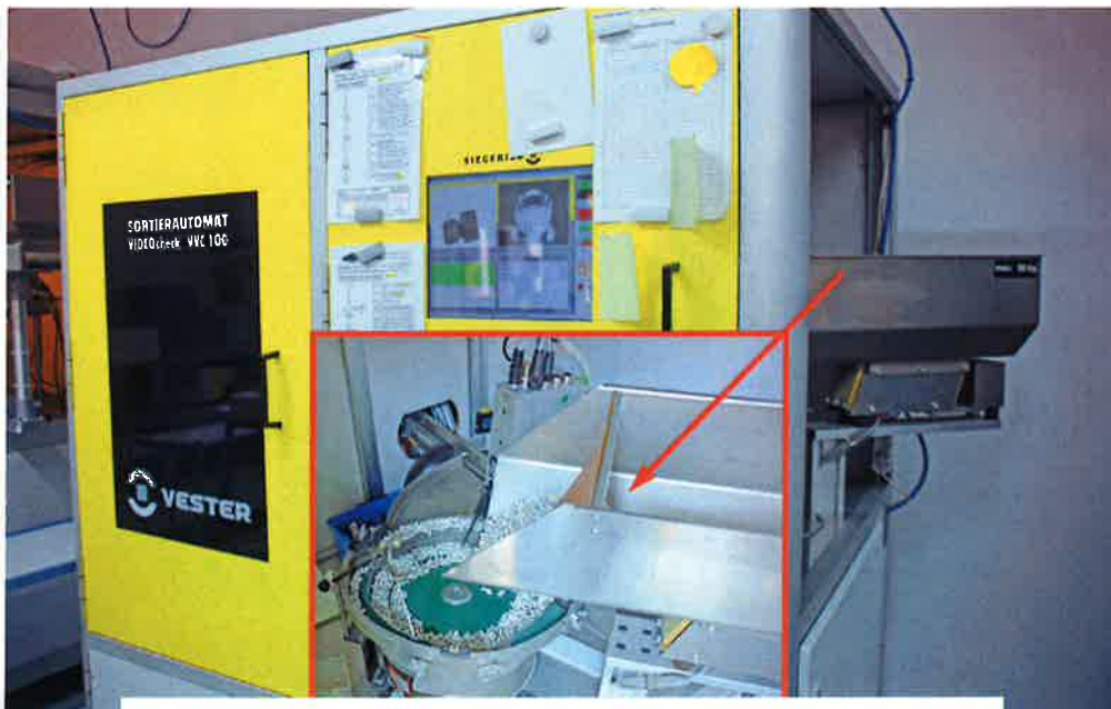
In diesem modernen Qualitätsprüfsystem werden die über einen Schwingtopf vereinzelt Teile mithilfe von Kameras zu 100 % auf Einhaltung der Sollmaße geprüft.
